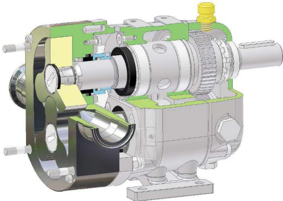
Le caratteristiche tecnico-idrauliche e le misure di ingombro della serie “BF” sono uguali alla serie “B”, quindi perfettamente intercambiabili tra di loro. Per ottenere un completo drenaggio del corpo pompante si possono applicare, a tutti i modelli, gli appositi piedi per la disposizione delle bocche in verticale.
