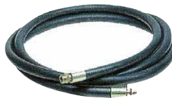
TUBO GOMMA VAPORE Press. di lavoro 15 Bar-110°C Press. di esplosione 45 Bar-110°C 3/4" (Ø 19x30) - 1" (Ø 25x38)
